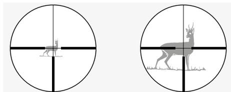
deel van het doel afgedekt. Het schatten van de afstand met behulp van het dradenkruis is maar in beperkte mate mogelijk.
