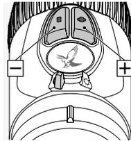
In dem von Ihnen gewählten Modus können Sie nun die Helligkeit mittels der +/- Tasten einstellen. Zum schnellen Finden der optimalen Helligkeit können Sie die Taste gedrückt halten (Dauerimpuls). Durch einmaliges Drücken der Tasten (Einzelimpuls) nehmen Sie die Feinjüstierung vor.
