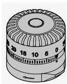
Erikseen määritettävällä flexballistiikkatornilla (BTF) kohde pysyy tähtäimessä halutuilla etäisyyksillä. Luodin putoamaa voidaan kompensoida käyttämällä sitä ylätornina. Sivutornina käytettäessä se soveltuu ihanteellisesti sivusäätöön tai ennakon määrittämiseen. BTF voidaan asentaa ilman työkaluja, ja se voidaan yhdistää mihin tahansa saatavilla olevaan ristikkoon.
