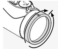
Drehen Sie erst den Dioptrienstellung ganz nach links (gegen den Uhrzeigersinn) und dann nach rechts, bis das Absehen die optimale Schärfe zeigt.
