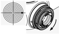
Vrid den yttre räfflade ringen på sidotornet i motsatt riktning mot R (dvs. medsols).
