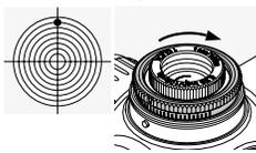
Tournez la bague moletée extérieure de la tourelle supérieure dans le sens inverse de la flèche H (sens des aiguilles d'une montre).
