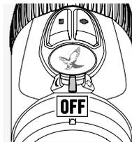
Drehen Sie hierzu den AUS/TAG/NACHT-Schalter in die Mittelstellung.
