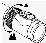
Ruotate l'anello di regolazione dell'ingrandimento di 180° per ottenere l'ingrandimento che desiderate. La regolazione avverrà di conseguenza. La scala sull'anello di regolazione consente una comoda visione delle impostazioni. Al fine di facilitarne l'orientamento, il morbido rivestimento scanalato dell'anello di regolazione presenta una piccola sporgenza.
