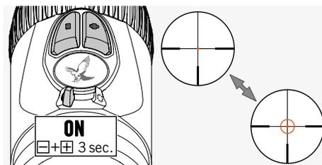
Drej kontakten FRA/DAG/NAT til positionen DAG eller NAT for at tænde for den oplyste ring på FLEXCHANGE 4A-IF sigtet. Sigtebelysningen er nu aktiveret. Tryk på knapperne +/- samtidigt i tre sekunder for at tænde for den oplyste ring. Gentag dette trin for at slukke for ringen igen.
