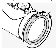
D'abord, tournez la bague d'ajustement dioptrique entièrement vers la gauche (sens inverse des aiguilles d'une montre), puis vers la droite, jusqu'à ce que la mise au point du réticule soit
