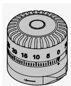
Det fleksible ballistiktårn (BTF) kan konfigureres separat og giver dig mulighed for at holde øjnene på byttet ved de ønskede afstande.
