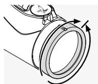
Drej først dioptriindstillingsringen helt til venstre (mod uret), og derefter til højre, indtil sigtet viser optimal skarphed. Indstillingsområdet afhænger af den individuelle model. Du kan finde
