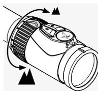
La anilla de ajuste de aumentos tiene un rango de giro de 180° para obtener el aumento deseado. El ajuste es continuo. La escala de la anilla de ajuste permite conocer en todo momento el nivel de aumento.
