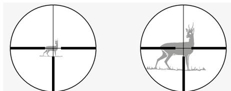
Même à un niveau de grossissement élevé, seule une très petite partie de la cible est dissimulée par le réticule. Le réticule ne permet d'estimer la distance que dans une certaine mesure.
