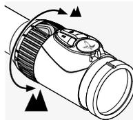
Genom att vrida förstöringsinställningsringen upp till 180° kan du ställa in önskad förstoring. Inställningen är steglös. Skalan på inställningsringen gör det enkelt att avläsa inställningen. Det
