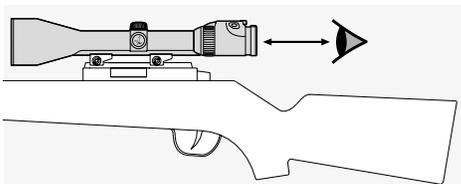
Indstil øjenafstanden korrekt for et sigte monteret på et våben (se det tekniske dataark for målingerne).
