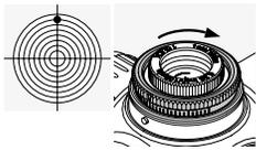
Vrid den yttre räfflade ringen på toppornet i motsatt riktning mot H (dvs. medsols).
