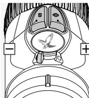
Vous pouvez maintenant régler le niveau de luminosité du mode sélectionné à l'aide des boutons +/- . Pour atteindre rapidement le niveau de luminosité idéal, appuyez longuement sur l'un des boutons et maintenez-le enfoncé. Pour effectuer des réglages précis, appuyez une fois brièvement sur l'un ou l'autre des boutons.
