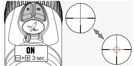
Drehen Sie den AUS/TAG/NACHT-Schalter in die TAG- oder NACHT-Position, um den beleuchteten Ring des FLEXCHANGE Absehens 4A-IF zuzuschalten. Die Absehensbeleuchtung ist nun aktiviert. Drücken Sie die +/- Tasten gleichzeitig für drei Sekunden um den beleuchteten Ring zuzuschalten. Wiederholen Sie diesen Schritt, um den beleuchteten Ring wieder wegzuschalten.
