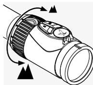
Drej indstillingsringen til forstørrelse helt op til 180° for at opnå den ønskede forstørrelse. Indstillingen foretages løbende. Skalaen på indstillingsringen gør det nemt at aflæse indstillingen.
