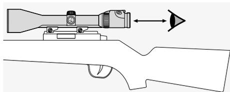
Impostate la giusta distanza della pupilla d'uscita per un cannocchiale montato su un'arma (consultate la scheda dati tecnica per le misure).
