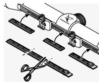
La protection fournie permet de protéger les parties exposées du rail de montage. Vous pouvez la couper aux dimensions souhaitées ; insérez-la dans le rail avec vos doigts.
