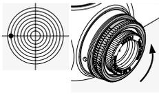
Tournez la bague moletée extérieure de la tourelle latérale dans le sens de la flèche R (sens inverse des aiguilles d'une montre).
