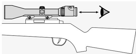
Ajuste la distancia ocular adecuadamente una vez que haya montado el visor sobre un arma (consulte las especificaciones técnicas adjuntas para conocer las medidas exactas).
