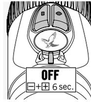
Sie können die SWAROLIGHT Funktion deaktivieren. Drehen Sie hierzu den AUS/TAG/NACHT-Schalter in die Mittelstellung und drücken dann die +/- Tasten gleichzeitig für 6 Sekunden. Ein zweimaliges
