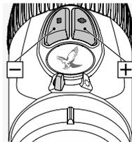
Ahora puede ajustar la luminosidad en el modo que haya seleccionado utilizando los botones +/- . Para lograr rápidamente el nivel ideal de luminosidad, puede pulsar y mantener pulsado uno de los botones (pulsación larga). Para realizar ajustes precisos, presione cualquiera de los botones una vez (pulsación única).
