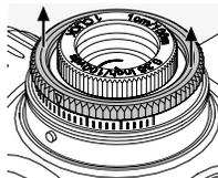
1. Løft den ydre drejeknap, og hold den i den hævede position, mens den drejes. Den forbliver ikke i den hævede position af sig selv.
