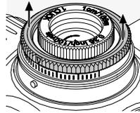
1. Heben Sie den äußeren Rändelring an, der in dieser Stellung gehalten und dann entsprechend gedreht werden muss. Er bleibt nicht selbstständig in dieser angehobenen Position.
