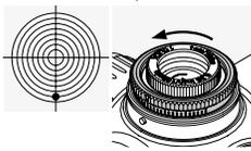
Tournez la bague moletée extérieure de la tourelle supérieure dans le sens de la flèche H (sens inverse des aiguilles d'une montre).
