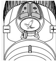
Du kan nu reglera ljusstyrkan i det valda läget med hjälp av knapparna + och -. För att snabbt hitta rätt ljusstyrka kan du hålla aktuell knapp intryckt (lång puls). Om du vill finjustera trycker du en gång på knappen (enstaka puls).
