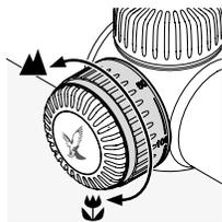
Con la torreta de paralaje, puede ajustar el enfoque para cada distancia al objetivo y evitar errores de puntería causados por el paralaje.
