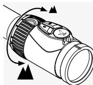
Draai de vergrotingsstelling tot maximaal 180° om de gewenste vergroting traploos in te stellen. De schaal op de stelling maakt een eenvoudig aflezen van de instelling mogelijk. Voor een
