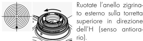
Ruotate l'anello zigrinato esterno sulla torretta superiore in direzione dell'H (senso antiorario).
