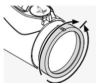
Primero, gire la anilla de ajuste de dioptrías completamente hacia la izquierda (sentido anti horario) y, posteriormente, gírela hacia la derecha hasta que vea la retícula nítida y enfocada.
