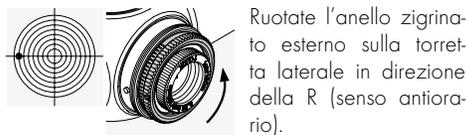
Ruotate l'anello zigrinato esterno sulla torretta laterale in direzione della R (senso antiorario).
