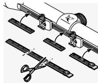
Предлагаемую заделку можно использовать для защиты открытых областей крепежной планки. Ее можно отрезать до требуемого размера и вдавить пальцами в крепежную планку.
