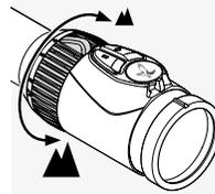
Durch Drehen des Vergrößerungsstellrings um bis zu 180° können Sie die gewünschte Vergrößerung stufenlos einstellen. Die Skala am Stelling ermöglicht ein einfaches und komfortables Ablesen der Einstellung. Zur besseren Orientierung besitzt der weiche, gerippte Stellingüberzug eine Nase.
