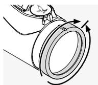
Käännä ensin silmäkohtainen säätörengas täysin vasemmalle (vastapäivään) ja sitten oikealle, kunnes ristikko on täysin tarkentunut. Säätövara vaihtelee malleittain. Lisätietoja on tuotteen teknisissä tiedoissa.
