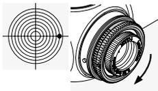
Draai de kartelring aan de buitenkant op de toren aan de zijkant tegen de pijlrichting R in (met de klok mee).
