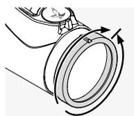
Ruotate prima l'anello di compensazione diottrica completamente verso sinistra (in senso antiorario) e poi verso destra, fino a raggiungere la nitidezza massima del reticolo.
