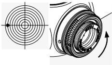
Vrid den yttre räfflade ringen på sidotornet i pilriktningen R (dvs. motsols).
