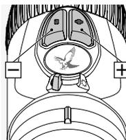
Затем с использованием кнопок +/- можно настроить яркость для выбранного режима. Для быстрого получения идеального уровня яркости можно нажать и удерживать одну из кнопок (длинный импульс).
