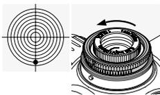
Draai de kartelring aan de buitenkant op de toren aan de bovenzijde in de pijlrichting H (tegen de klok in).
