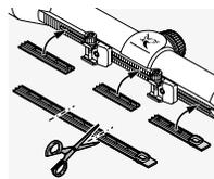
De bijgevoegde afdekking kan worden gebruikt om de open railgedeelten te beschermen. Knip de afdekking op de gewenste lengte af en druk deze met je vingers in de rail.
