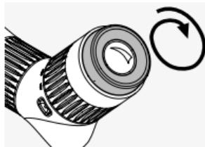
Para utilizarlo con gafas: enrosque la copa ocular giratoria (en el sentido de las agujas del reloj) hasta el tope.
