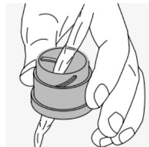
为确保您的单筒望远镜拥有持久卓越的光学性能，您需要让玻璃表面远离尘土和油脂。如需清洁光学器件，应首先用光学镜头刷清除较大的尘土颗粒。然后在镜头上轻轻呼气，用清洁布去除残留的污垢。
