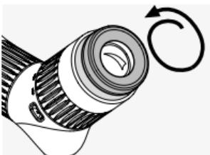
Verwendung ohne Brille: Drehen Sie die Drehaugenmuschel (gegen den Uhrzeigersinn) bis zum Anschlag heraus.
